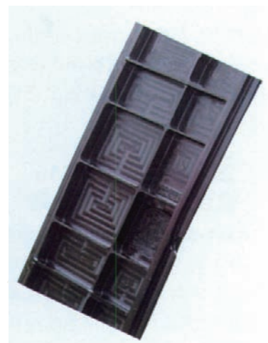
图8 激光快速成形TA15钛合金工件精加工状态实物图
