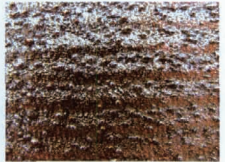
图2 激光快速成形钛合金零件表面粘附粉末形貌实物照片
